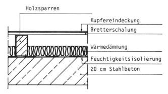
Fig. 1 Dachaufbau
