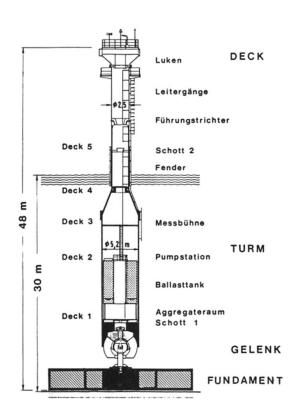
Fig. 1: Schnitt durch das Bauwerk
