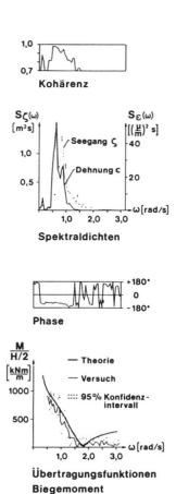
Fig. 4: Ergebnis der spektralanalytischen Auswertung
