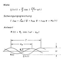
Fig. 3: Grundlagen für die hydromechanische Betrachtung
