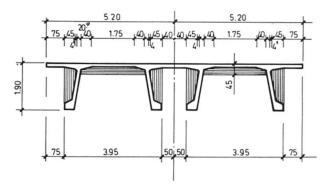
Fig. 4 Section transversale de l'ensemble du tablier
