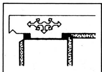
**Fugendichtungen im Hoch- + Tiefbau**
