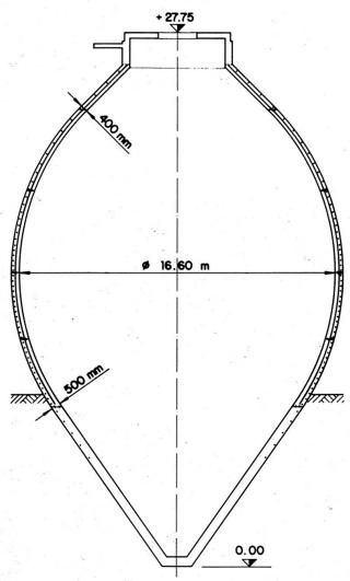
Der erste der beiden Faulbehälter im Bau- Bild 2: Schnitt durch einen der eiförmigen Behälter
