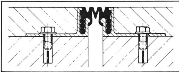
**Fugendichtungen im Hoch- + Tiefbau**
