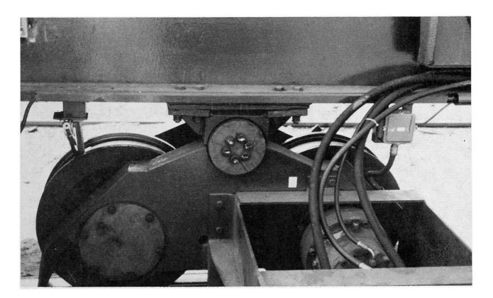
Bild 3 Antrieb eines Kranlaufrades – Hydraulikantrieb
