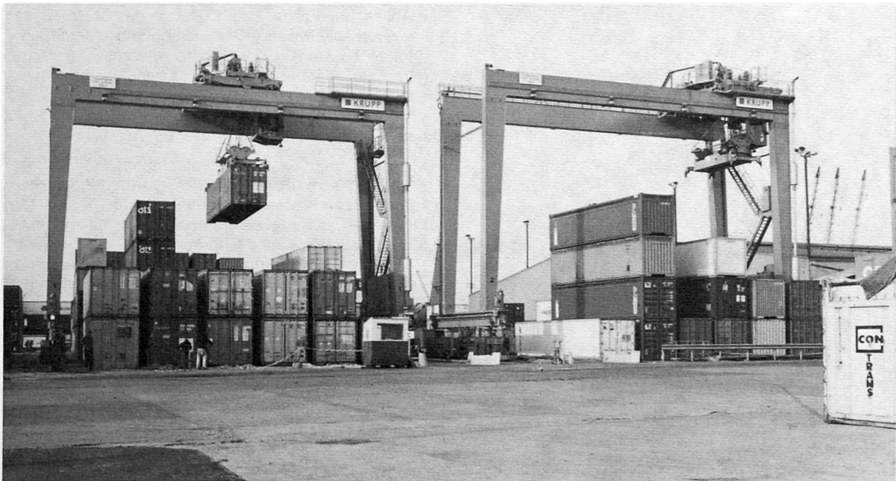
Drei neue automatisierte, gummibereitete Container-Stapelkrane im Hamburger Hafen mit einer Tragfähigkeit von 45 t und 15 m Hubhöhe (Foto Krupp)
