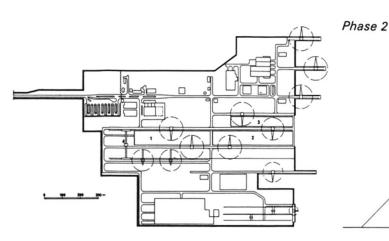
Bild 1 Gesamtübersicht der Schiffswerft im Endausbau 1, 2+3: Trockendocks; 4: Portalkran
