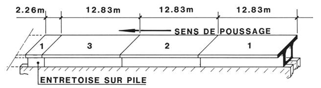
Fig. 3 Bétonnage d'une travée courante
