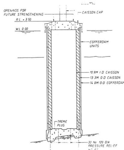
Fig. 3 Pier 2 Caisson
