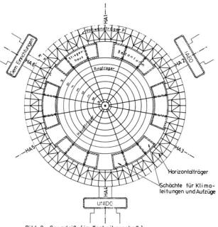
Bild 3 . Grundrifi (im Technikgeschofi)
