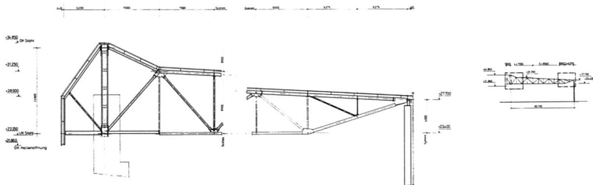
Alle Stützen in den Giebelwänden und der Rückwand sind als Stahlverbundstützen ausgebildet,  $0,6 \times 0,8$  m. Ihr Raster beträgt 10 m; die Höhe der Rückwandstützen ca. 28 m, die Giebelwandstützen max. 31 m. Die Dachpfetten liegen im Abstand von 3 m als Durchlaufträger über die Binder mit 10 m Spannweite.
