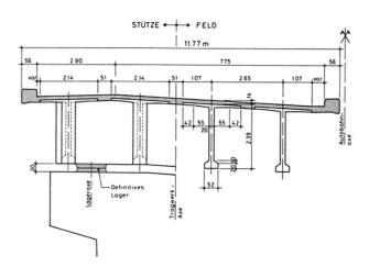
Bild 1 Brückenquerschnitt
