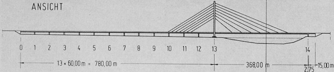
Die Rheinbrücke Düsseldorf-Flehe ist mit ihrer Stromöffnung von 365 m zu der Zeit die weitestgespannte einhüftige Schräglagelängsbrücke der Welt. Für den Brückenträger im Stromfeld wurde Stahl gewählt, für den Brückenträger im übrigen Bereich und für den Pylon hat sich Beton als preisgünstiger und technisch einwandfreier Baustoff erwiesen. Der Pylon wurde von einer Btiergemeinschaft unter der Federführung von Dyckerhoff & Widmann AG geplant und gebaut.
