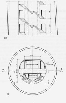
Schaft, Aufzugschächte und Treppenanlage a) Ansicht und Schnitt A - A b) Horizontalschnitt
