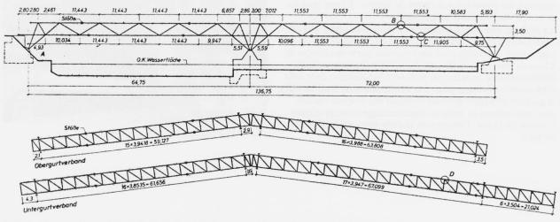
Bild 2: Systemskizzen-Zweigelenk-Fachwerkrahmen und Aussteifungsverbände
