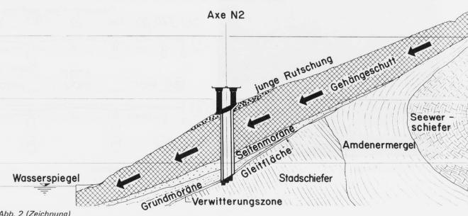
Abb. 2 (Zeichnung) Typisches geologisches Querprofil mit Gesamtbrückenquerschnitt bis zur Fundation
