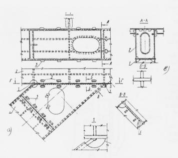
Fig. 5 Raccordement des béquilles inclinées au caisson de la poutre principale: a) vue en face; b) coupe transversale; 1 - le caisson de la béquille inclinée; 2 - le caisson de la poutre principale; 3 - les cornières de fixage; 4 - le diaphragme en tôle.
