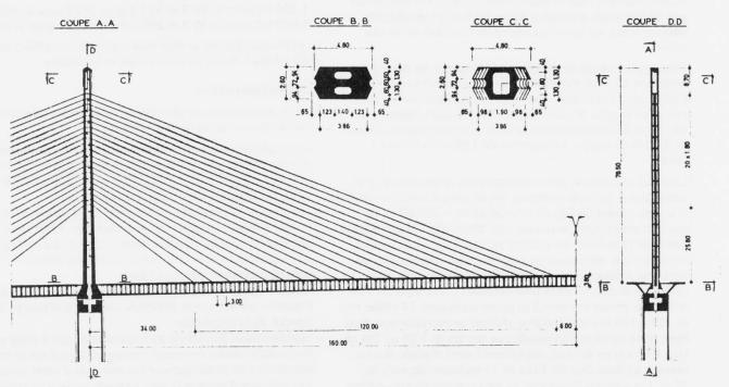
Fig. 4 - Elévation d'un demi-fléau et mât
