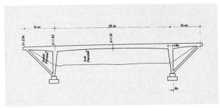
Bild 4 Westautobahn Kreuzungsbauwerk, Anschlussstelle St. Georgen Längsschnitt (1961)
