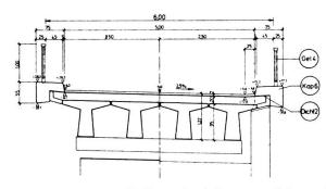
Bild 2: Regelquerschnitt für Hauptwirtschaftswege aus Trägern mit Spannbettvorspannung
