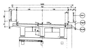
Bild 3: Regelquerschnitt für Hauptwirtschaftswege aus Trägern mit Vorspannung durch Spannglieder
