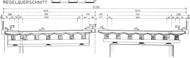
Bild 7: Regelquerschnitt für eine vierbahnige Autobahn aus Trägern mit Spannbettvorspannung
