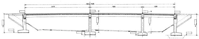
Bild 1: Darstellung der Regelstützweiten
