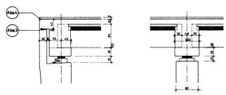
Bild 4: Detail 'Querträgerausbildung' über Innenstützen und auf Widerlagern
