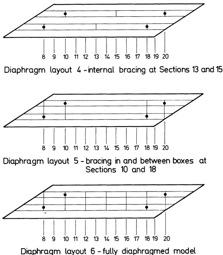
Fig. 14b. Diaphragm Layouts 4-6.
