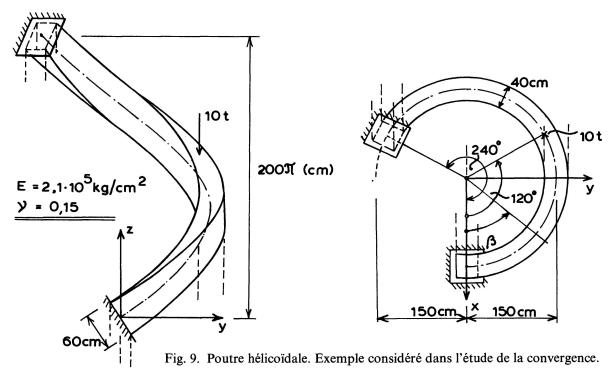
En complément, le tableau 2 donne encore la comparaison entre la solution basée sur l'élément quintique et les résultats obtenus en remplaçant la poutre hélicoïdale par une succession de segments rectilignes. Il apparaît clairement que même avec 32 éléments rectilignes, on n'atteint pas la qualité des résultats obtenus avec deux éléments courbes seulement.
