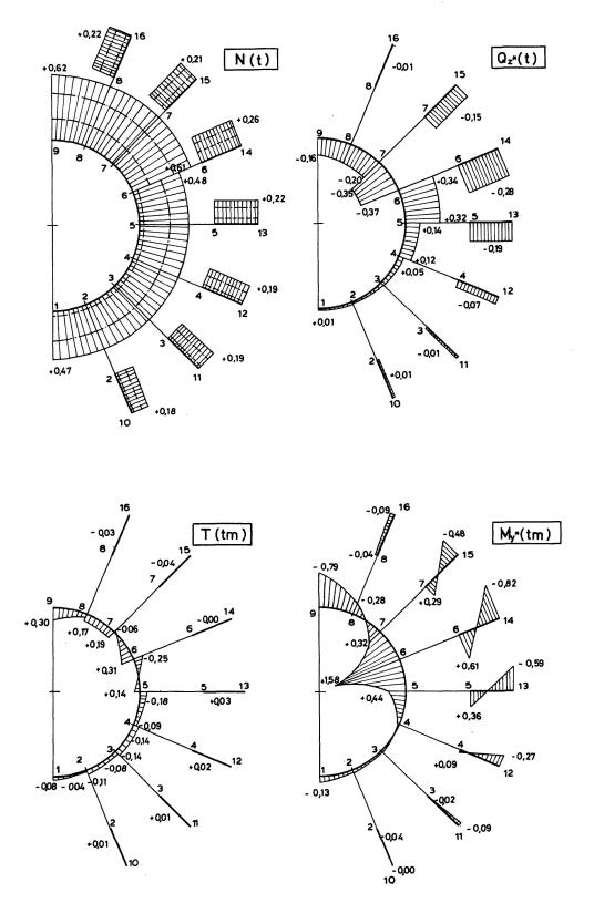
Fig. 18. Efforts internes engendrés dans la rampe hélicoïdale de la figure 17 par une force P=1 tappliquée au nœud 6.
