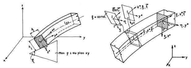
Fig. 2. Définition géométrique d'une section nodale. En partant des valeurs  $x_L$ ,  $y_L$ ,  $z_L$  et  $b_L$ ,  $h_L$ ,  $\phi_L$  données, les nœuds auxiliaires L' et L'' seront déterminés à l'aide des relations résumées dans l'appendice.
