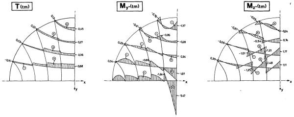
Fig. 13. Moment de torsion et moments fléchissants engendrés dans les barres de la coupole sphérique de la figure 10 par une force isolée P = 10 t, appliquée au sommet. L'axe principal y\* des sections est horizontal  $(\varphi = 0)$ .
