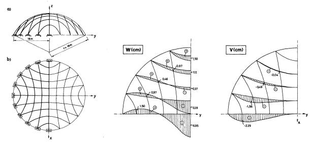
Fig. 10. Coupole sphérique constituée par un grillage de barres courbes de l'espace.
