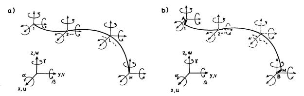
Fig. 6. Elément spatial de barre courbe et ses forces nodales.
