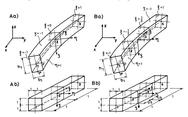
Fig. 1. Deux membres de la famille d'éléments spatiaux de barres courbes de section rectangulaire variable (a) obtenus par distorsion de leurs éléments de base (b): élément quadratique (A), élément cubique (B).
