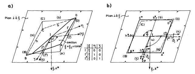
Fig. 4. Projection de la section  $\xi = \xi_I$  sur le plan perdiculaire à l'axe et détermination des axes locaux  $x^*$ ,  $y^*$  et  $z^*$ .
