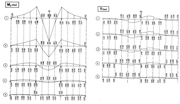
Fig. 15. Diagrammes des moments fléchissants dans les poutres maîtresses du pont courbe de la figure 14.
