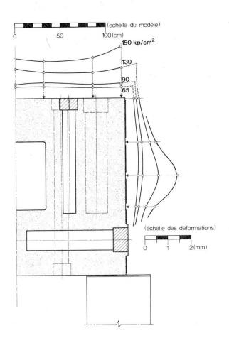
Fig. 11. Déformée du modèle.
