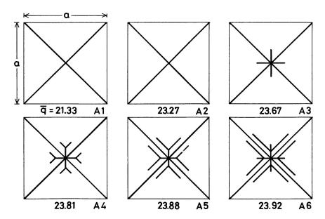
Abb. 6/2. Fliessgelenklinienfigur für eine allseitig frei drehbar gestützte Quadratplatte unter Gleichlast Grenzlastintensität:  $\overline{q} = q a^2/Mp$ .
