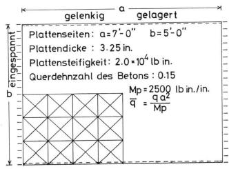
Plattenabmessungen, Stoffgesetz und Elementunterteilung. Abb. 6/8.
