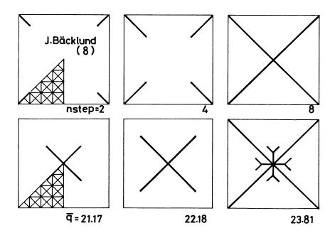
Abb. 6/4. Vergleich mit der Fliessgelenklinienfigur in [8].
