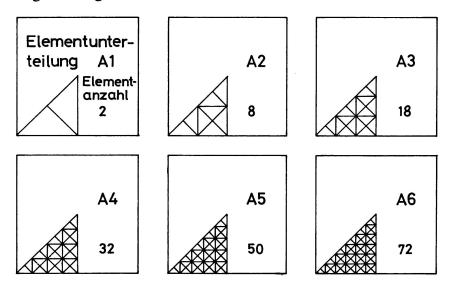
Abb. 6/1. Verfeinerung der Elementunterteilung für die Konvergenzuntersuchung an einer allseitig frei drehbar gestützten Quadratplatte.
