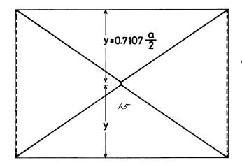
Abb. 6/10. Fliessgelenklinienfigur für b/a = 0.7143 in der Fliessgelenklinientheorie.
