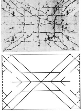
Abb. 6/9. Gegenüberstellung des experimentellen und des rechnerischen Bruchbildes.
