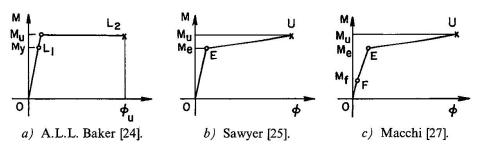
Fig. 4. Modèles du matériel élastique dans les méthodes de «compatibilité».
