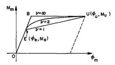
Fig. 5. Modèles de comportement inélastique des sections fléchies en béton armé [32].
