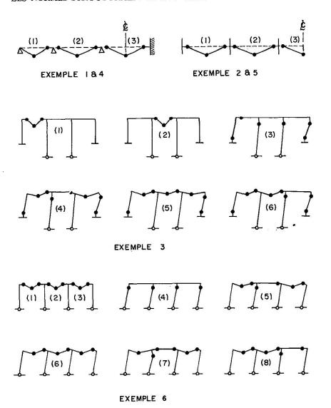
Fig. 8. Mécanismes de ruine plastique des structures de la fig. 7.
