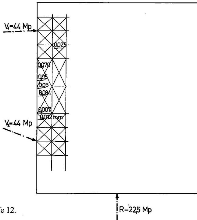
Abb. 13. Rissbreiten bei Laststufe 12.
