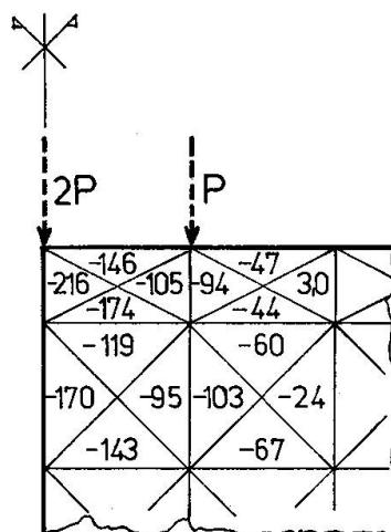
Abb. 7. Spannungen  $\sigma_x [\text{kp/cm}^2]$  bei  $V = 44 \text{ Mp}$ .
