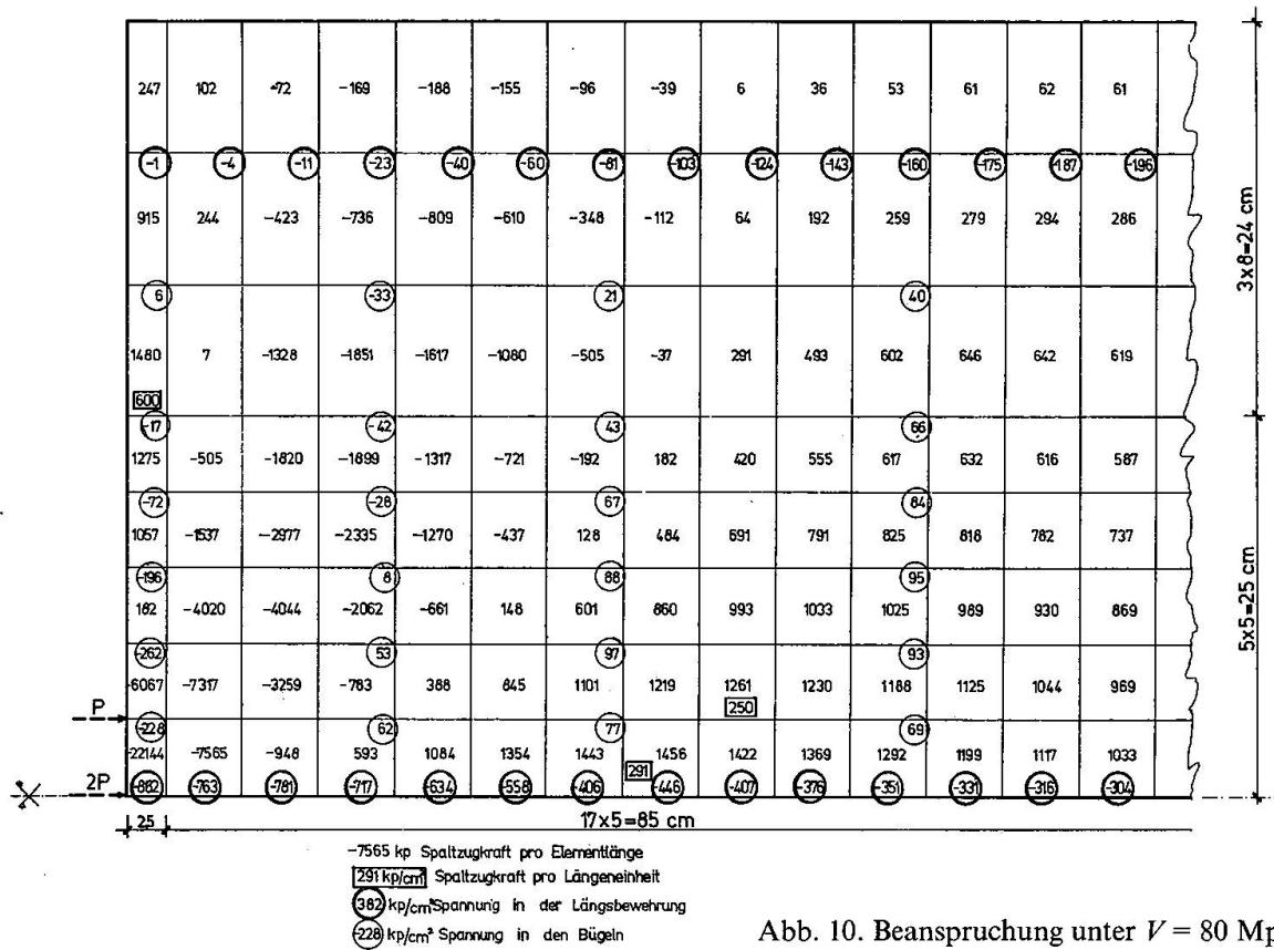
Abb. 10. Beanspruchung unter  $V = 80 \text{ Mp}$ .*Beispiel: Unsymmetrische Krafteinleitung*
