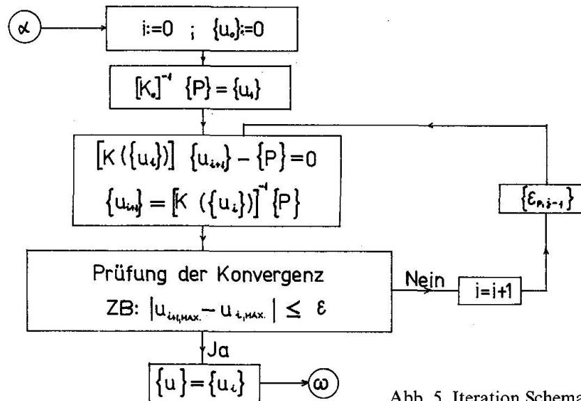
Abb. 5. Iteration Schema.
