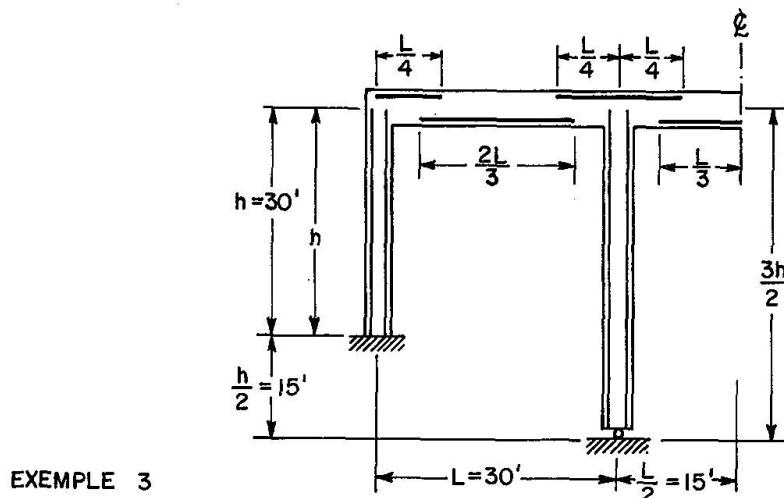
Fig. 9. Détails d'armature des structures de la fig. 7.
