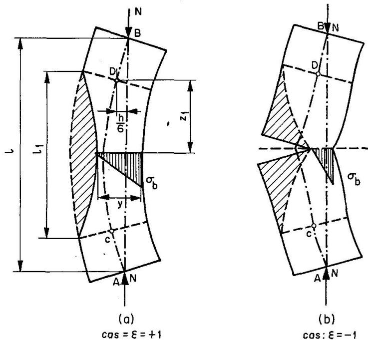
Soit  $l_1 = 2z$ , la longueur de la «zone fissurée» assimilable à un «empilage». L'égalité des rotations à la limite de la zone fissurée conduit à la relation suivante:
