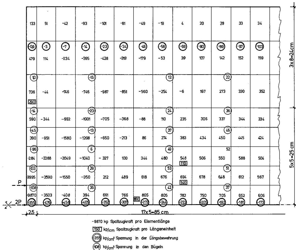
Abb. 8. Beanspruchung unter  $V = 2 + 2P + P = 44 \text{ Mp}$ .
