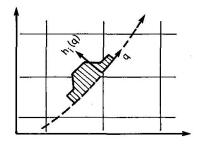
Fig. 2. Charge répartie dans la direction du mouvement.
