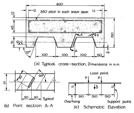
Fig. 1. Typical details of specimens DS1 to DS4.
