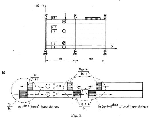
A la fig. 2a, nous montrons un disque continu divisé en g bandes. Nous supposons que, par portée, la résultante de la charge dans la direction X est égale à zéro. Nous verrons au paragraphe 4 que cette hypothèse est nécessaire; rappelons que cette restriction est acceptable dans la plupart des problèmes pratiques. Dans le cas des ponts, elle correspond aux problèmes où il n'y a pas de forces de freinage.
