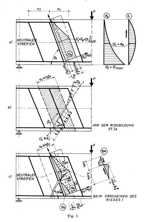
Wächst die Balkenbelastung bis zu der des Gebrauchszustandes, so wächst auch die Stahlbeanspruchung, so dass der Schrägriss sich öffnet. Die vom Verfasser durchgeführten Versuche [4] zeigten, dass bei niedrigen Laststufen die Rissöffnung proportional mit der Laststufe wächst.
