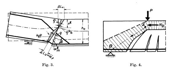
Querbewehrung grösser ist als bei der Längsbewehrung. Dieses Gleiten führt zur Verkürzung der gedrückten Betonfasern und letzten Endes zur Verlängerung des Schrägrisses (Fig. 3).
