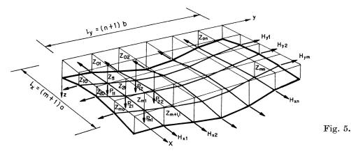
Das Gleichgewicht des Knotenpunktes j, k wird mit der Gleichung
