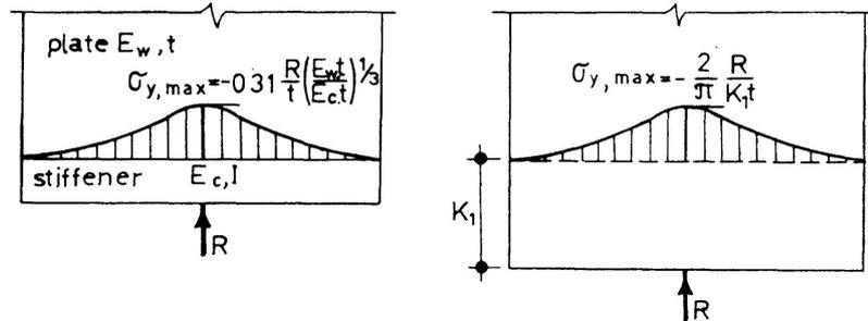
Fig. 9. Equivalent depth  $K_1$ .
