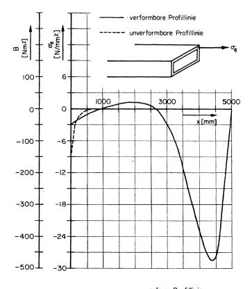
Fig. 5.2. B und  $\sigma_e$  Funktionen von x.
