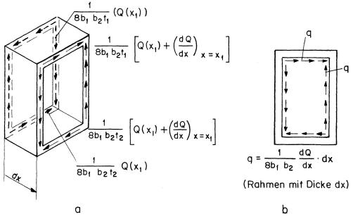
Fig. 4.1. Zusätzliche Schubspannungen.
