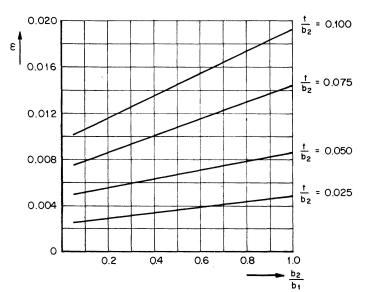
Fig. 6.3.  $\epsilon$  Funktion von  $b_2/b_1$ .
