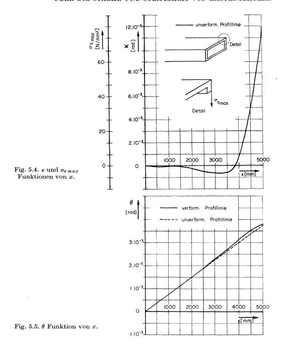
Ausserdem ist auf die Biegespannungen Rücksicht zu nehmen, die, nach der Theorie der flexiblen Profillinie, bei einem Abstand von ungefähr 500 mm der Einspannstelle maximal sind. Diese Spannungen kann man aber bestimmt nicht vernachlässigen.
