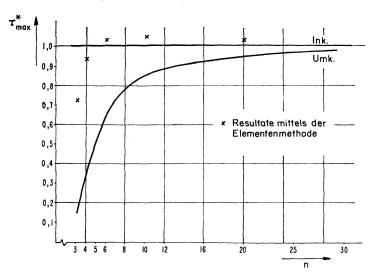
Graphik 5.2. Vergleich der maximalen Schubspannung.
