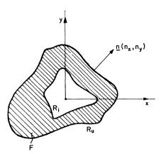
Fig. 6.1. Mehrfach zusammenhängender Querschnitt.
