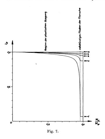
$\vartheta\,GJ_D$ in Abhängigkeit vom Plastizierungsgrad  $M_K/M_{gr}$ sowie der Stegfeldzahlm.
