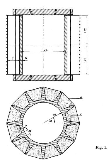
Der erstgenannte ist in statischem Sinne als eine Kreisringplatte anzusehen. Die Untersuchung darf damit auf die Wand beschränkt werden. Falls im folgenden über den Behälter bzw. das Gefäss gesprochen wird, so ist unter dieser Bezeichnung die Seitenkonstruktion zu verstehen.
