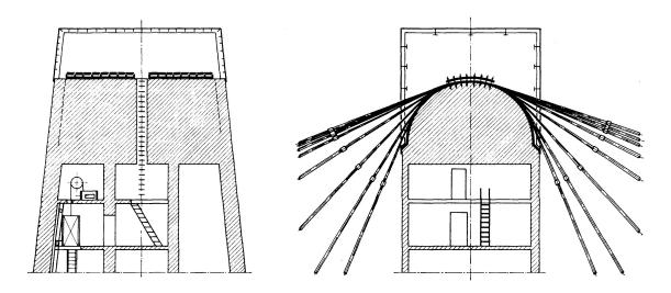
Fig. 43. Pylonenkopf mit durchlaufenden Kabeln (Entwurf Messinabrücke).
