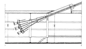
Fig. 39. Schnitt durch Hohlkasten-Hauptträger der Rheinbrücke Düsseldorf Nord mit Kabelverankerung.
