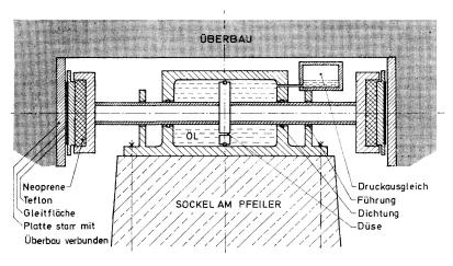
Fig. 4. Bremskraftableitung bei Eisenbahnbrücken über ölhydraulische Puffer an den Pylonen.
