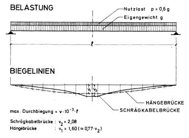
Fig. 9. Durchbiegungen des Einfeld-Systems unter Vollast.
