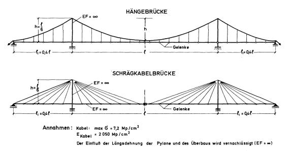
Fig. 12. Dreifeld-System zum Vergleich der Durchbiegungen.
