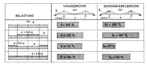
Fig. 27. Schwingbreiten der Kabelspannungen für Hängebrücke und Schrägkabelbrücke.
