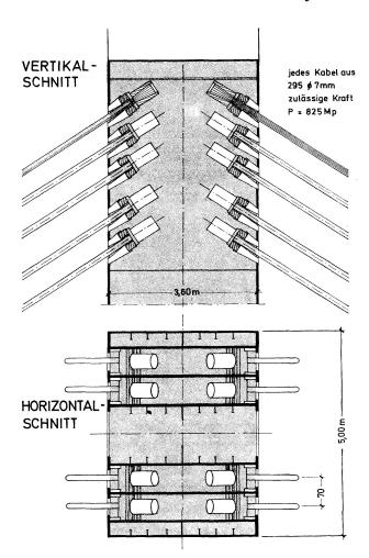
Fig. 42. Pylonenkopf Rheinbrücke Mannheim – Kabel getrennt und verankert.
