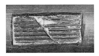
Fig. 32. 10 Jahre altes Paralleldrahtbündel mit Zementinjektion – Prüfstelle – Drähte und Zementstein einwandfrei.
