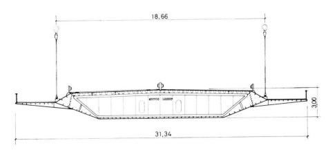
Fig. 20. Querschnitt der Severnbrücke, Entwurf Freeman, Fox und Partner, London.
