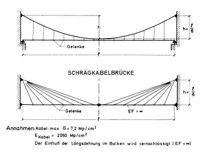
Fig. 8. Einfeld-Systeme zum Vergleich der Durchbiegungen.
