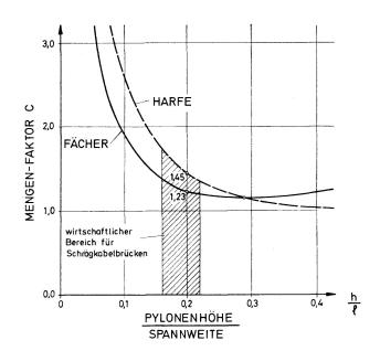
Fig. 36. Kabelstahlmenge für Fächer und Harfe.
