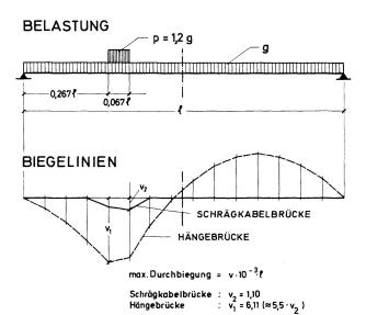
Fig. 11. Durchbiegungen des Einfeld-Systems unter Einzellast.
