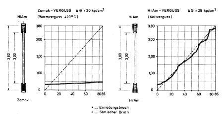
Fig. 29. Verteilung der Drahtbrüche bei Dauerversuchen und anschliessenden statischen Bruchversuchen bei Zamak-Metall-Verguss und HiAm-Verguss.
