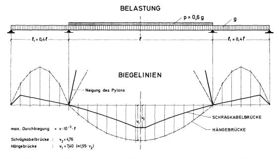
Fig. 13. Durchbiegungen des Dreifeld-Systems unter Vollast im Mittelfeld.
