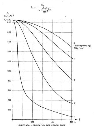
Fig. 6. Abhängigkeit der Kabelsteifigkeit von Spannung und Länge.
