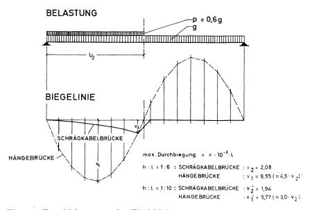
Fig. 10. Durchbiegungen des Einfeld-Systems unter halbseitiger Last.
