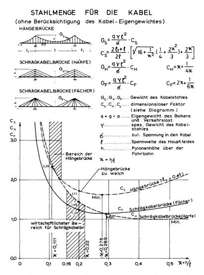
Fig. 15. Stahlmengen für die Kabel als Funktion von h/l.
