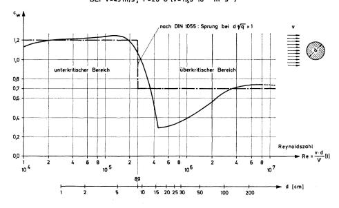
Fig. 35.  $c_W$ -Werte von Kabel<br/>n in Abhängigkeit von Reynoldszahl und Kabeldurchmesser.
