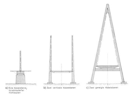
Fig. 38. Anordnung der Kabelebenen im Querschnitt.
