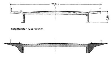
Querschnitt mit zusätzlicher Verkleidung hätte die Windstabilität bei Montage erhöht
