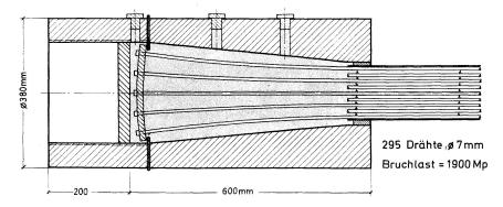
Fig. 28. HiAm-Verankerung, Schnitt durch den Ankerkopf, Stahlkugelverguss.
