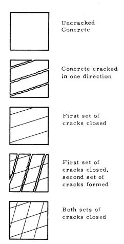
Fig. 15. Crack Modes.
