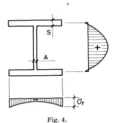
c) Le type 3 est celui des profils «compacts» où les semelles se refroidissent en premier et l'âme en dernier, à cause de la chaleur qui se dégage des semelles épaisses [3]. La fig. 4 donne l'allure des contraintes résiduelles.
