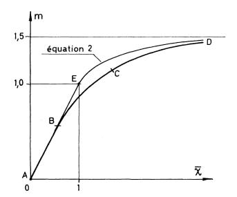
Phase élastique. L'évolution des contraintes dans une semelle, soumise aux contraintes résiduelles de la fig. 2, est représentée à la fig. 13. Vu le sens choisi pour m, c'est la fibre supérieure qui se plastifiera en premier. On est donc en stade élastique tant que  $|\bar{\sigma}_0| \leq 1$ .
