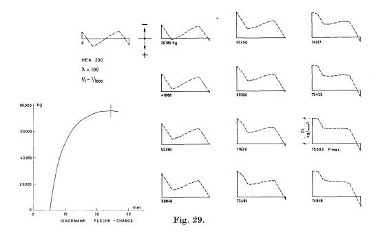
Pour les petits élancements ( $\bar{\lambda} < \sim 0.75$ ), la ruine s'accompagne d'une plastification presque complète de la section; le cas 1 (fig. 25a), permettant cette plastification plus rapidement, est alors déterminant.
