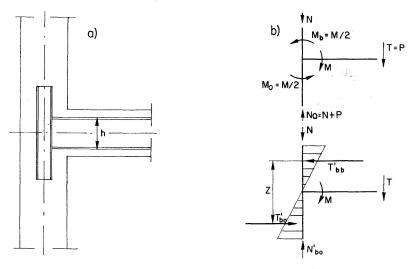
Fig. 9. Nœud du type «Tête à marteau».
