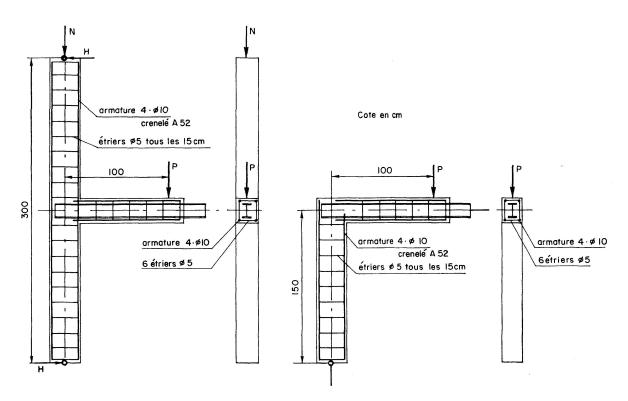
Fig. 1. Schema d'essai. Armatures des nœuds essayés. Barres d'encastrement non figurées.
