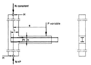
Fig. 8. Schema de l'essai d'un nœud à 3 branches.
