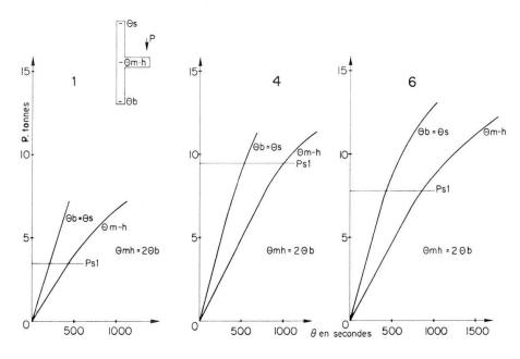
Fig. 37. Rotations de la colonne en fonction de la charge P.
