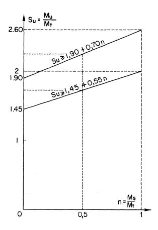
Fig. 22. Variation de la sécurité ultime  $S_u$  en fonction de n.
