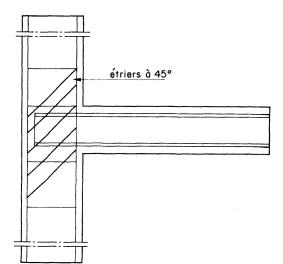
Fig. 21. Disposition des étriers à 45° dans la zone du nœud.
