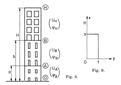
$\begin{array}{lll} -- & \text{au niveau } 0: & V_A(0) &= 0, \\ -- & \text{au niveau } A & V_A(a) &= V_B(a), \\ V_A'(a) &= V_B'(a), \\ -- & \text{au niveau } B & V_B(b) &= V_H(b), \\ V_B'(b) &= V_H'(b), \\ -- & \text{au niveau } H & V_H'(H) &= 0. \end{array}$
