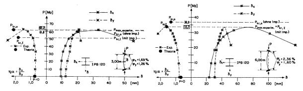
Fig. 7c. Last-Verformungs-Diagramm für Versuch 2.1.
