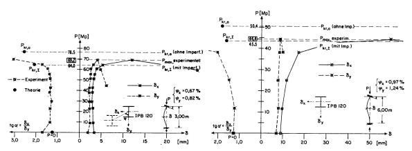
Fig. 7a. Last-Verformungs-Diagramm für Versuch 1.1.
