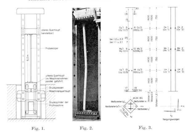
Fig. 1. Prinzipskizze der Prüfmaschine. Fig. 2. Stütze 2.2 ( $l=6,0\,\mathrm{m}$ ) in der Prüfmaschine (nach dem Versuch). Fig. 3. Lage der Meßstellen.
