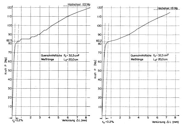
Fig. 4. Kraft-Verkürzungs-Diagramm der Säule 1 (stub-column-test).
