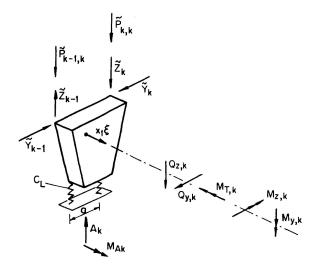
Fig. 7. Balkenelement am elastisch gestützten Rand.
