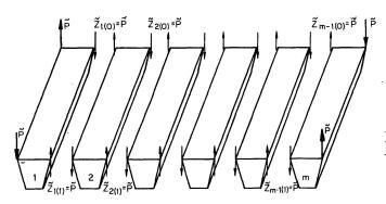
Fig. 10. Darstellung des Kräfteverlaufs in der tordierten Balkenreihe.
