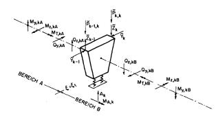
Fig. 8. Balkenelement über einer elastischen Zwischenunterstützung.
