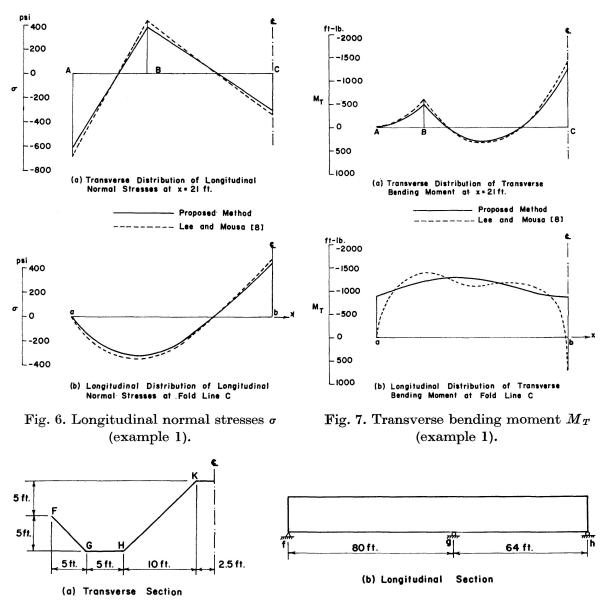
Fig. 8. Shell dimensions (example 2).
