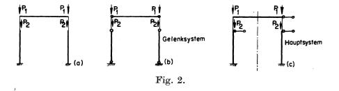
(Fig. 2b), bei dem leicht zu erkennen ist, wo die zur Gewinnung des unverschieblichen Hauptsystems benötigten 3 Ostenfeldschen Festhaltestäbe angeordnet werden müssen. Diese Festhaltestäbe sind starr und werden an den Knoten gelenkig angeschlossen. Unter der hier gegebenen Belastung weisen sie keine Kräfte auf  $(Z_0=0)$ .
