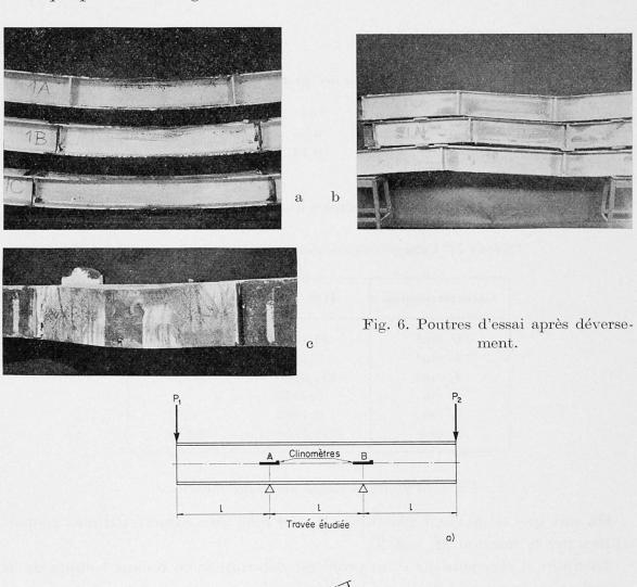
Fig. 7. Mesure de la rotation plastique  $\theta$  à l'aide de deux clinomètres.
