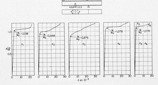
Fig. 9. Diagrammes  $M/M_p$ - $\epsilon$  (poutre n<sup>0</sup> 5).
