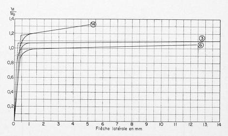
Fig. 10. Diagrammes moment-flèche latérale.
