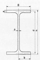
Fig. 5. Caractéristiques géometriques des profils étudiés.
