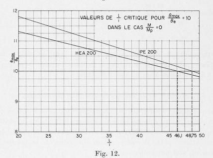
Par interpolation, on a relevé la valeur optimum  $l_{cr}/i_y$  pour une capacité de rotation  $\theta_{max}/\theta_e=10$ .
