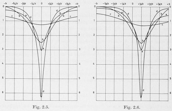
a) courbe expérimentale, b) méthode proposée, c) méthode Guyon-Massonnet, d) pont extrêmement déformable par cisaillement.
