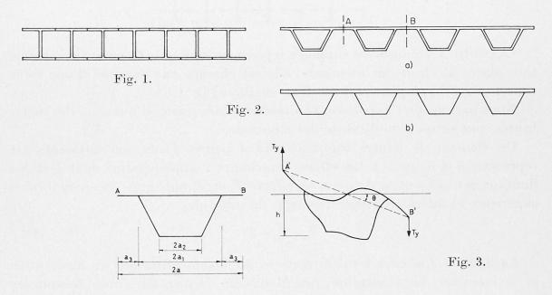
b) Les ponts formés de profils tubulaires tout en béton (fig. 2a), ou partiellement en acier (fig. 2b), reliés par une dalle en béton, mais ne possédant pas d'entretoises. La grande déformabilité de ces ponts au cisaillement provient de ce que chaque poutre tubulaire individuelle, telle que celle qui s'étend de A à B (fig. 2a) peut se déformer par cisaillement transversal de la façon représentée à la figure 3, ce qui a pour conséquence une dénivellation sensible entre les points A et B.
