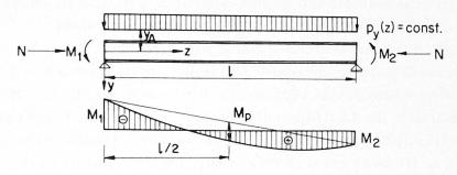
Fig. 1. Belastungsbild des untersuchten einfeldrigen doppeltsymmetrischen I-Trägers.
